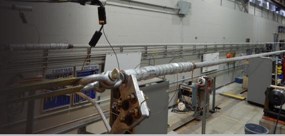
Le laboratoire indépendant Kinetics Lab a effectué les essais de type des connecteurs DMC Power sertis par le système Swage sur différents calibres de câbles ACSR et ACSS. Tous les connecteurs soumis se sont conformés à tous les critères des normes de gouvernance. Celles-ci sont :
