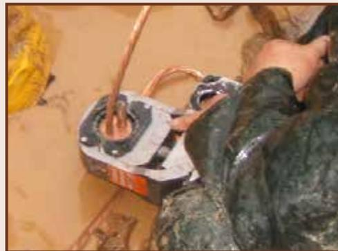
*L'outil de sertissage Swage est compact et portable produisant une force identique de façon répétée et est d'usage facile sous toutes conditions.*
