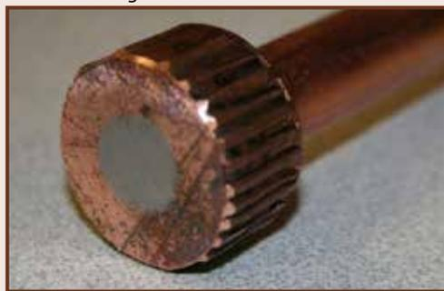
*La compression sur 360° réduit les vides permettant une meilleure conduction et une plus faible élévation de température.*
